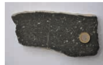
Polierter Phonolith – in der dunklen Grundmasse sind wenige helle Einsprenglinge von Feldspat (Sanidin) zu erkennen.
